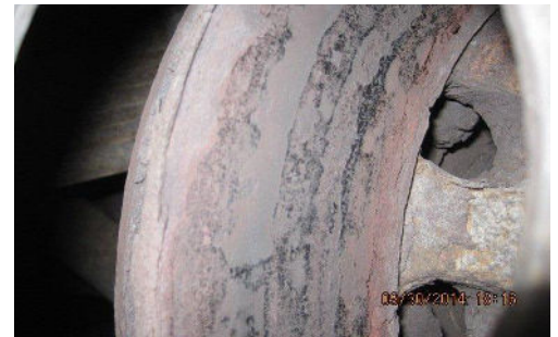
Rusted Rotor. OOSC, Part II, a.(6)(d) or a.(7)(e) / 393.48(a)-U.S.
